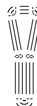
Obr. Šipce podobný symbol na vnitřních stranách hlavového a nožního čela označující střed ložné plochy
