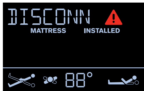
Obr. ODPOJENÉ VZDUCHOVÉ TRUBKY
